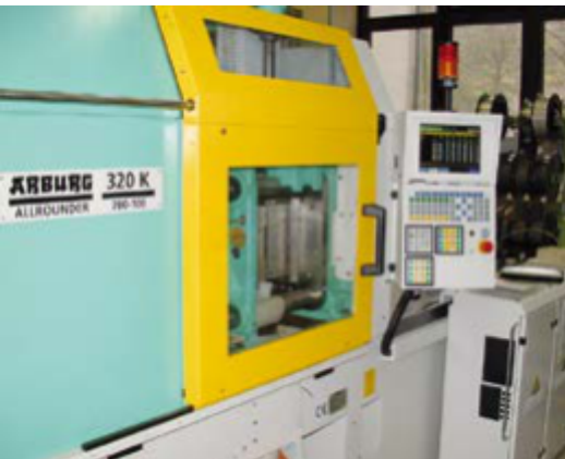
ARBURG Spritzgussmaschine in Kombination mit eigenentwickelter Drahtzuführeinrichtung
