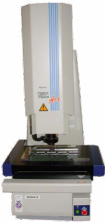
Berührungslose, CNC-gesteuerte optische Vermessung der Bauteile
