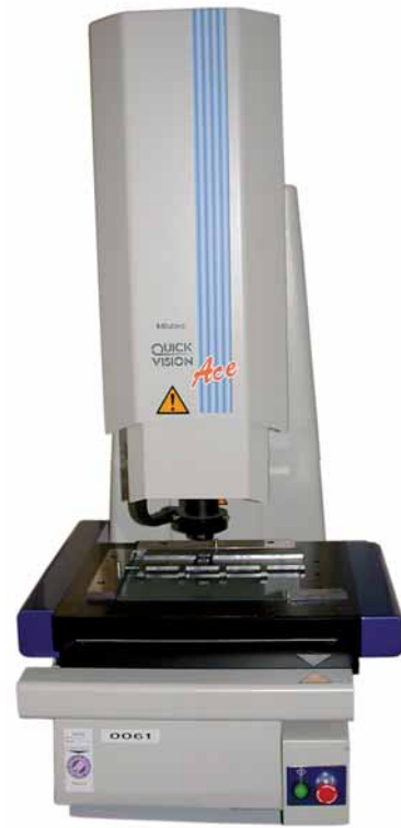
Berührungslose, CNC-gesteuerte optische Vermessung der Bauteile
