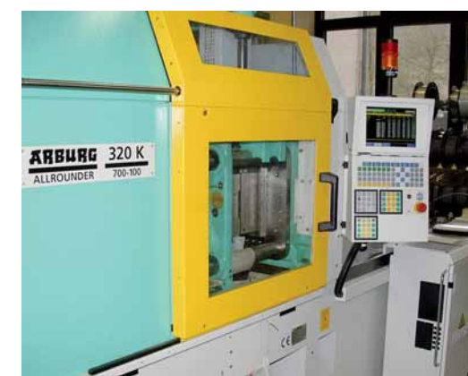
ARBURG Spritzgussmaschine in Kombination mit eigenentwickelter Drahtzuführereinrichtung
