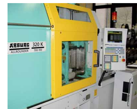
ARBURG Spritzgussmaschine in Kombination mit eigenentwickelter Drahtzuführereinrichtung
