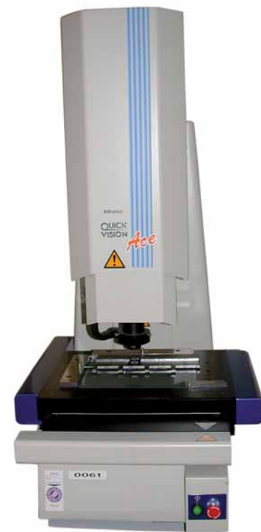
Berührungslose, CNC-gesteuerte optische Vermessung der Bauteile
